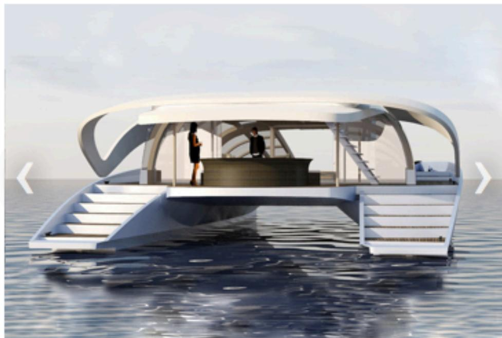
Подход «умеренность во всем» диктует и выбор двигателей. Их два, всего по 260 л.с., и максимальная скорость составляет 20 узлов. Расход топлива – 42 л/час на скорости в 12 узлов. Благодаря двум
